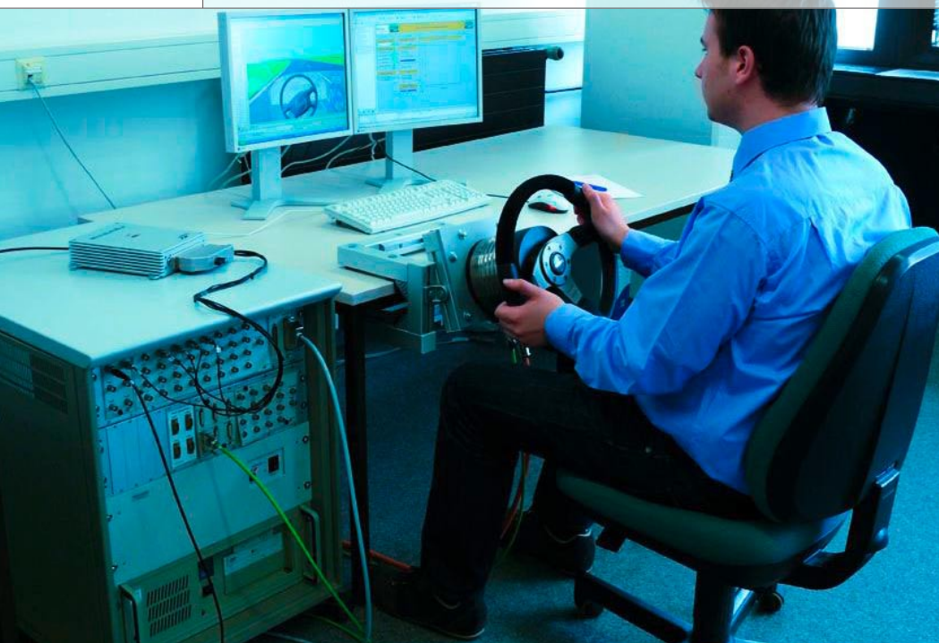
Abbildung 1: HIL-Prüfstand mit Feedback-Lenkrad.
